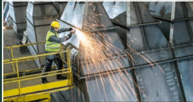
Conçue pour les travaux difficiles : la meuleuse d'angle avec moteur Marathon utilisée en continue dans la construction de conteneurs
